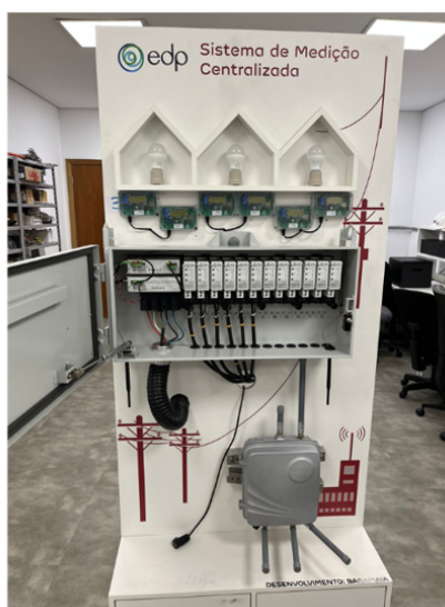
Figura 7 - SMC Pantheon da Hexing em testes no laboratórioFonte: Elaborada pelo autor (2025)
